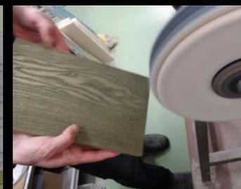
弊社が誇る製造技術により、ABS、アクリル、木材、発泡材など、様々な素材を鋳物の質感、金属質な重厚感を表現します。
