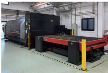
大型ファイバーレーザー機でSUS、真鍮、銅、アルミなど非鉄金属の加工が可能。さまざまな厚み、仕上げ、裏面加工に柔軟に対応いたします。
