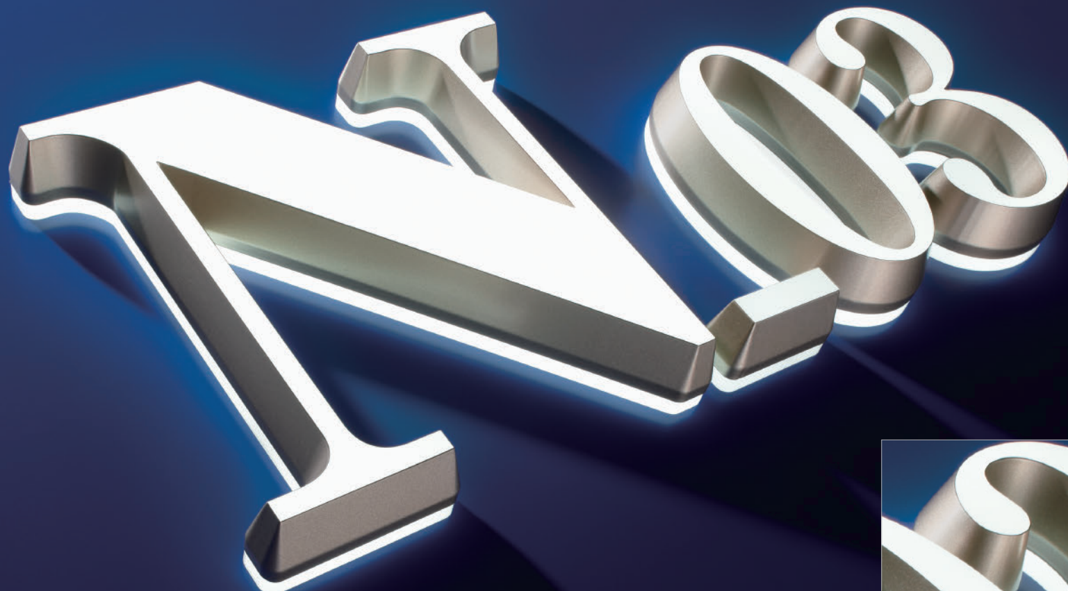
[Photo-N_03] | 発光色：白（6500K） | 拡散樹脂：t20 × 15° + ストレートカット | 側面塗装色：シャンパンゴールド塗装 | 裏板：乳半アクリル t5
