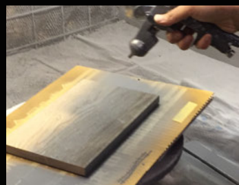
〈塗装色〉丸型:MC-01 ブラス 雲型:MC-05 ガンスモーク 〈加工素材〉 プレート:ABS t8 テーパー8° 文字:塩ビシート
