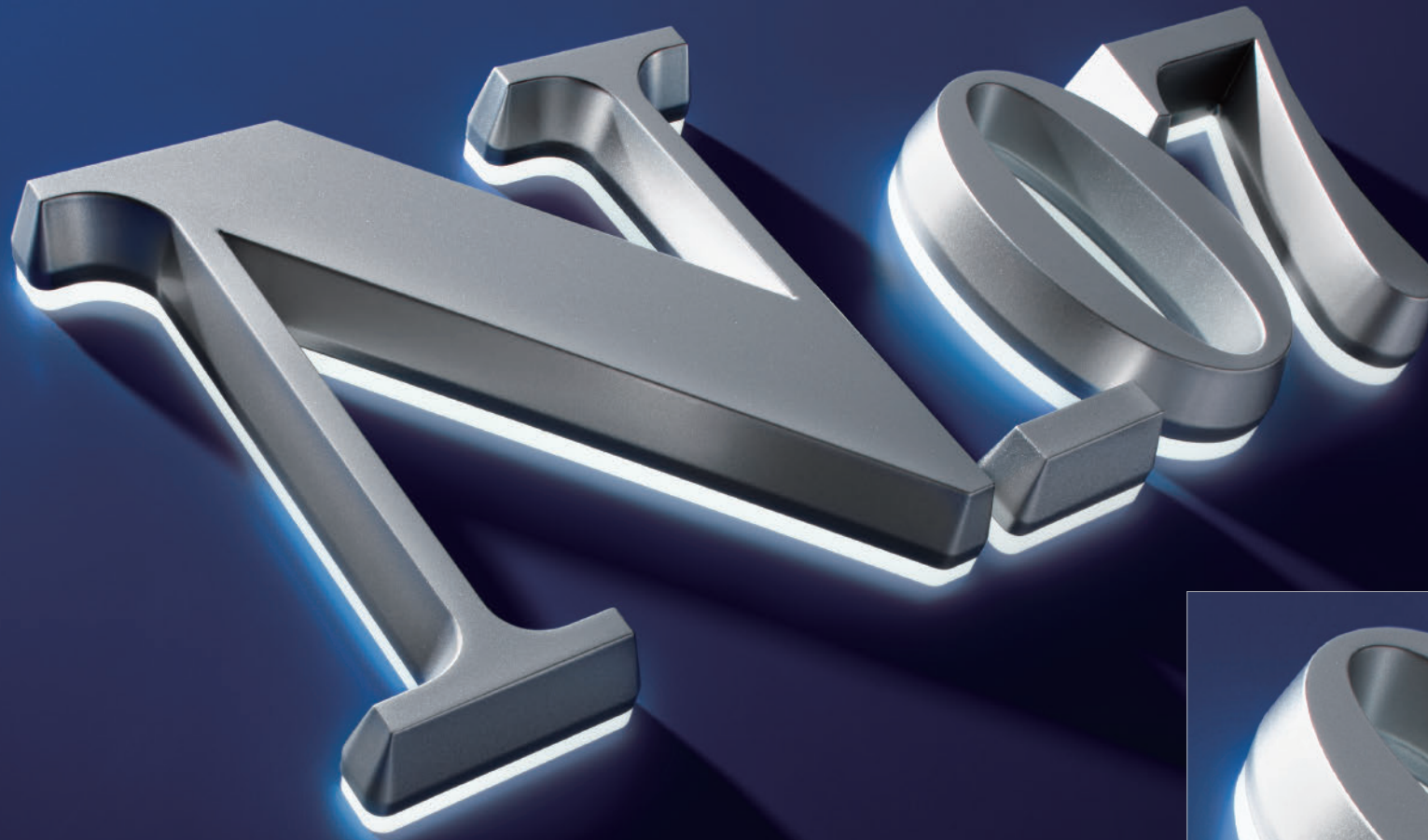
[Photo-N_07] | 発光色：白（6500K） | 拡散樹脂：t20×15°+ストレートカット | 乳半アクリルt5 | 正面・側面塗装色：シルバーマタリック(荒目)
