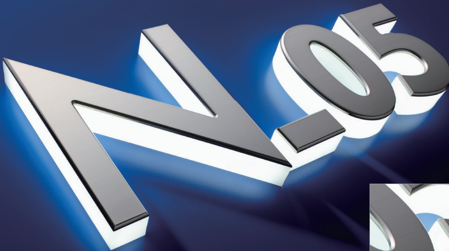
[Photo-N_05a] | 発光色：白（6500K） | 拡散樹脂：t20ストレートカット | 正面：ABS t3×3R ニッケルHLメッキ
